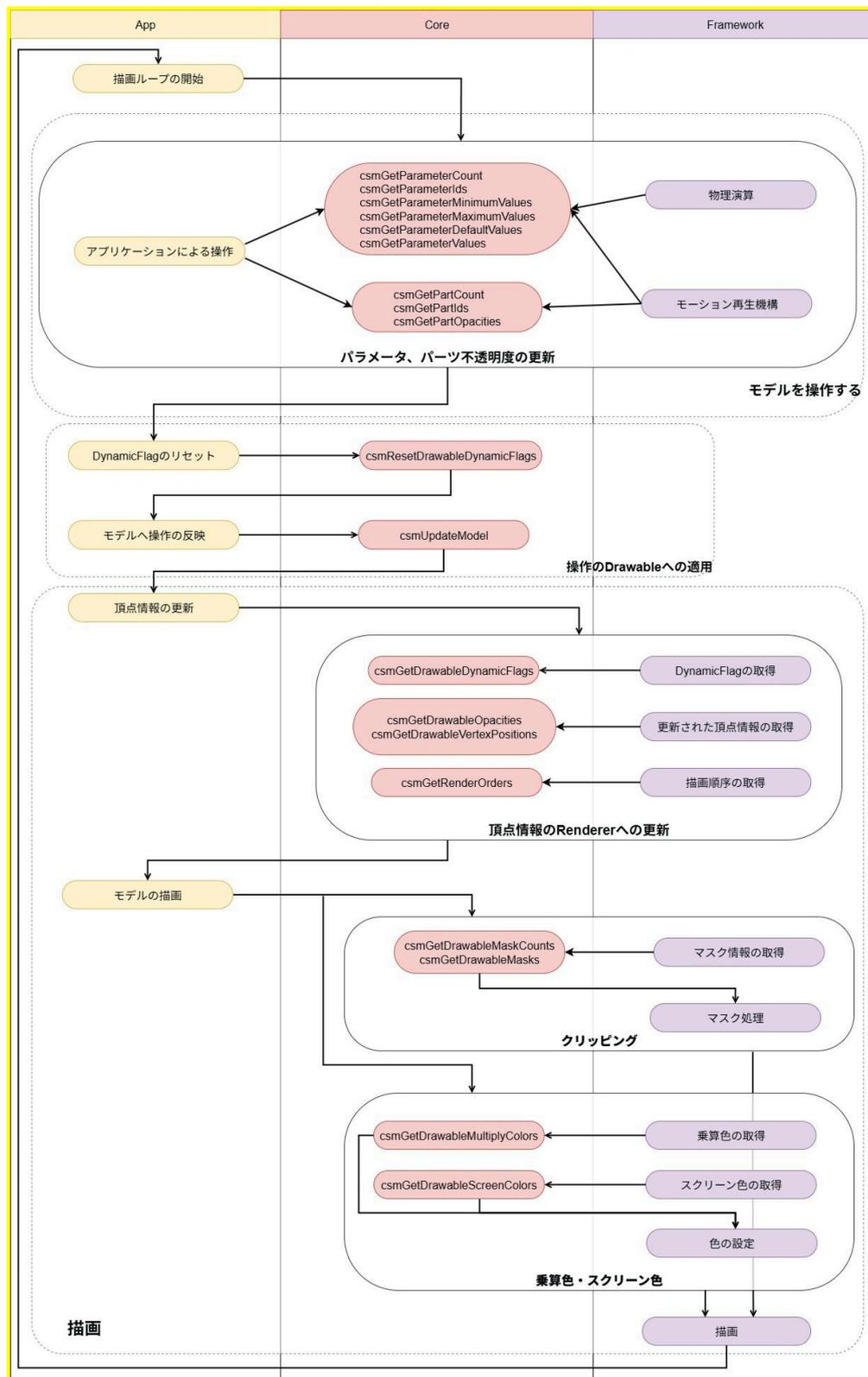
先ほどの図と同じく、黄色のノードがApplication、紫のノードがFrameworkで処理すべき部分で中央のCoreへ矢印が引かれているノードは、CoreのAPIを呼び出しを示しています。実線で囲まれた部分は簡易化している部分です。
