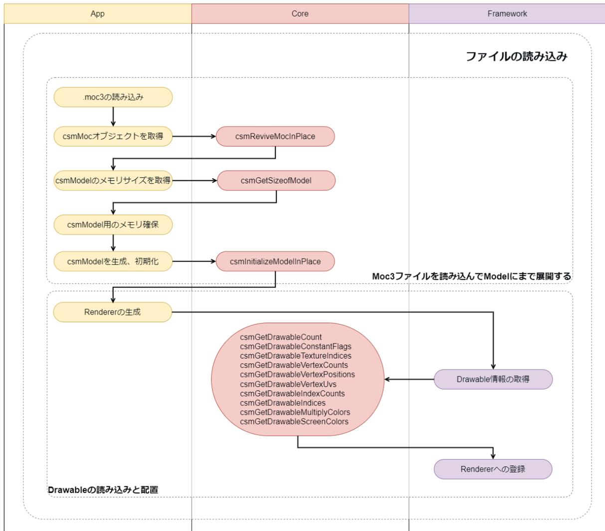
黄色のノードがApplication、紫のノードがFrameworkで処理すべき部分で中央のCoreへ矢印が引かれているノードは、CoreのAPIを呼び出しを示しています。
